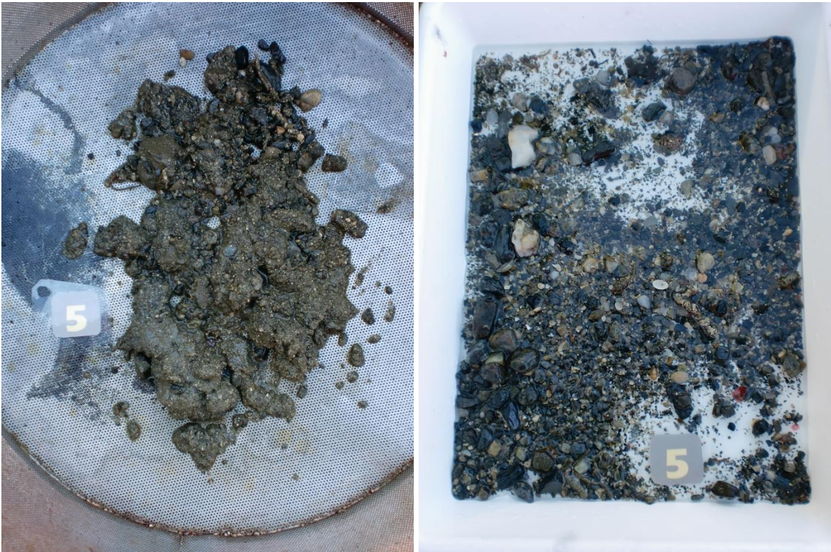
Figur B-5: Bilde som viser sedimentet fra stasjon 5 før og etter siling. Sedimentet besto av silt, grus, stein og fjellbunn.
