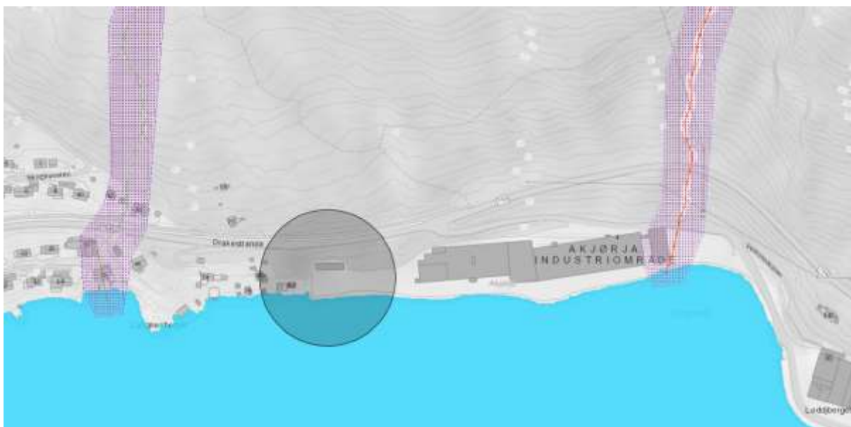
Figur 5-5: Aktsomhetsområder for flom (lilla) og områder som kan bli usatt for havnivåstigning/stormflo (blå). Planområdet inngår i sirkelen (kilde: NVE).
