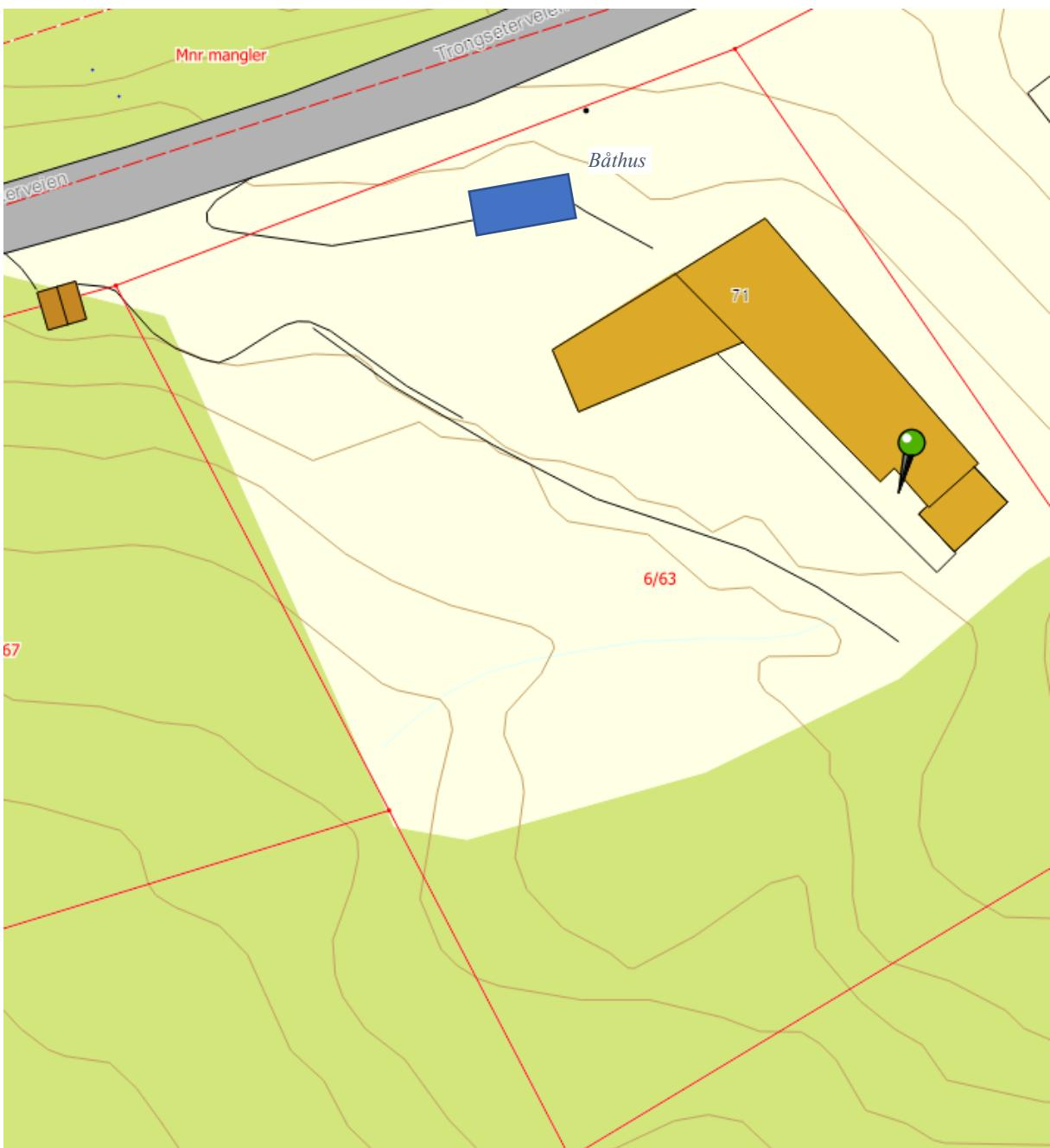
Tilbygget er et "båthus" primært for lagring av trebåt på tilhenger. Arealet er 11m<sup>2</sup> (2,3x4,8). Mønehøyde er ca 2,7 m (inn mot eksisterende bygg) – rafthøyde ca 2 m ut mot Trongseterveien. Avstand til eksisterende bygg er ca 5 m, avstand NØ til nabo 6/61 er ca 10 m. Avstand til grense NV v/Trongseterveien er ca 2 m, avstand til veirygg ca 4 m.
