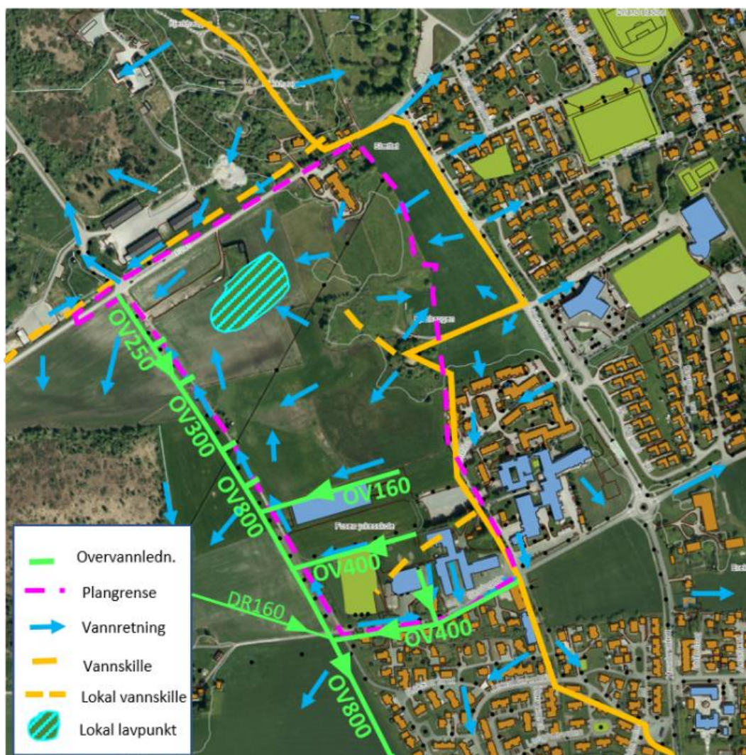
Figur 4. Vannretning med vannskille i eksisterende situasjon.
