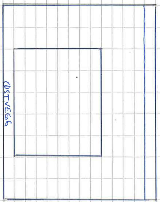
Vi snudde takvinkel fra øst mot vest til at taket faller nord mot sør. Dette før å unngå snøras mot 'gammelegga'. Bygget virker desuten mindre spaltig fra hovedveien. Det ble og enklere å installere vedovn og praktisk utnyttelse av bygget.
